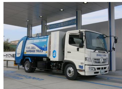
(b) 開発した燃料電池ごみ収集車
