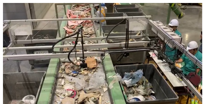
図3 協力工場におけるプロトタイプの自動選別ロボットの実験
