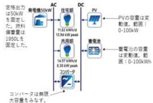
図1 マイクログリッドモデルの構成図
