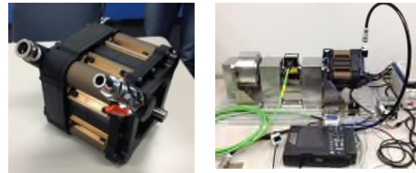
図4 圧縮空気エンジンの外観および性能評価試験装置
