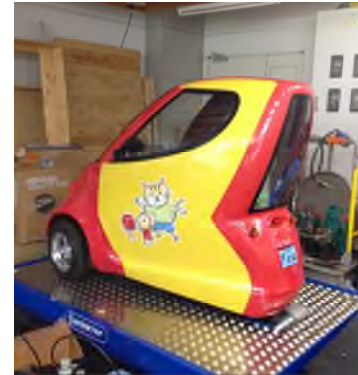
図4 シャシーダイナモによるULV-Aの走行試験
