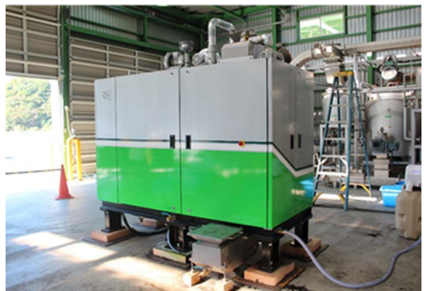
図5 過熱水蒸気法によるトレファクション試験装置
