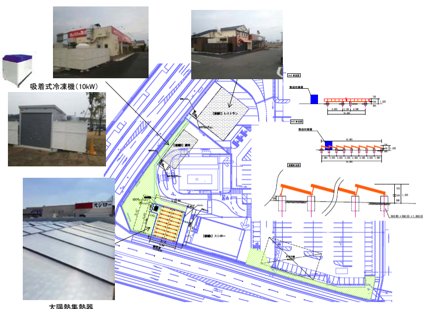
図2 飲食店街における太陽熱・地中熱複合利用システム(本庄市)
