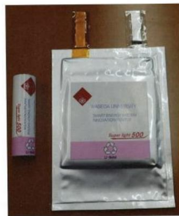
図1 早稲田大学が試作した金属Li負極電池のイメージ 当初は右のラミネートセルを想定。写真の電池の正極の寸法は7cm×7cmだが、実用化時には10cm×10cmにする計画(写真:日経エレクトロニクス)
