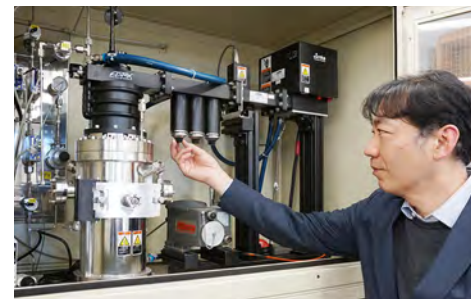
真空チャンパー内に、メタンなど炭素源となる素材を導入し、結晶成長させる。
