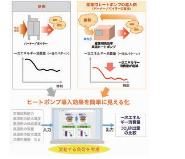
図 開発した「産業用ヒートポンプシミュレーター」
