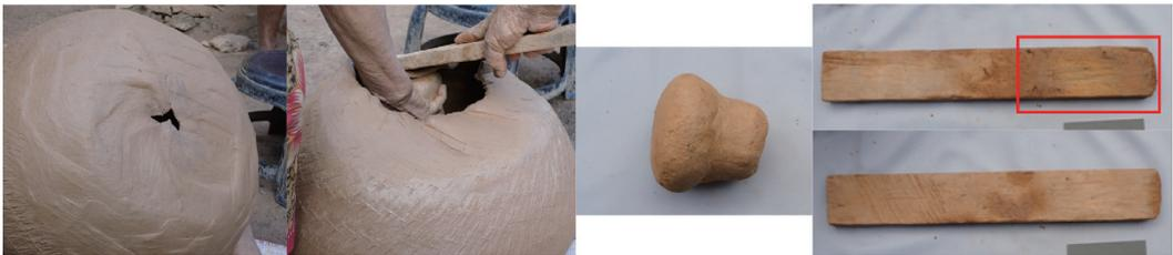
図8：製作工程⑧（底部の作出）で用いる工具
