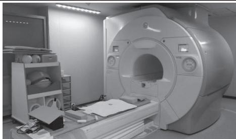
マグネットガントリーが設置されており、被験者の撮像を行なう部屋です。この部屋は外部ノイズ混入を防ぐための電波シールドが施されています。また検査室にはMR信号を受信するためのアンテナ（受信コイル）が設置されています。
