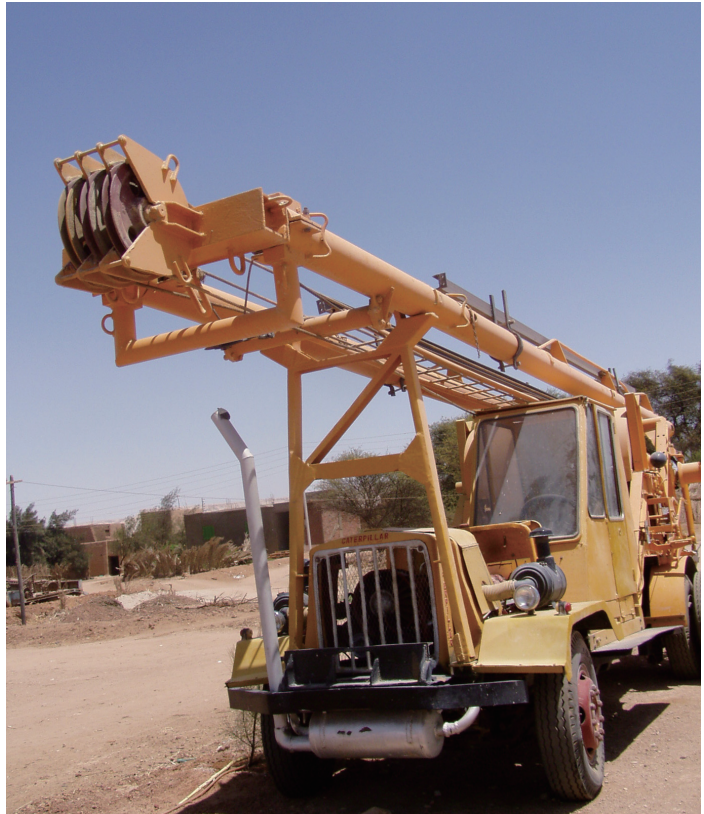
富農が所有する井戸の掘削機、ダブラ・オアシス
